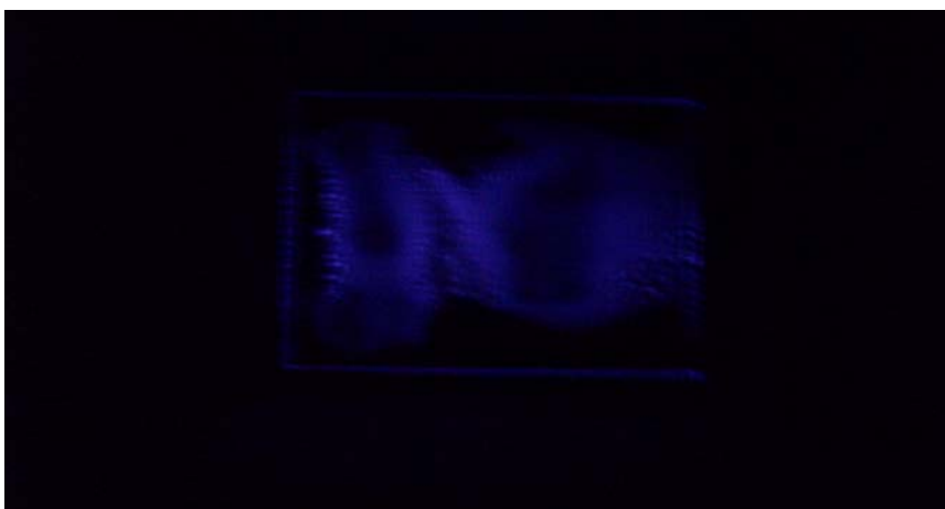
Bild 5: Fokussierte Entladung in partiellen Barrierenbezirken (Flächenansicht)
